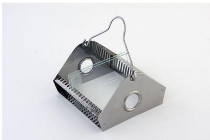
Berço para coloração de lâminas, posicionadas horizontalmente, para análise histológica, patológica ou microbiológica. Fabricado em chapa de aço inox.
