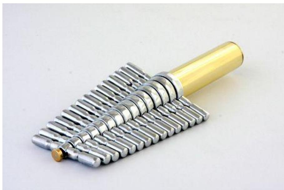
É um utensílio que permite produzir orifícios de diferentes diâmetros, em rolhas de cortiça ou de borracha.
