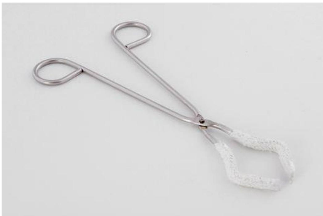
Pinça para frasco e balão fabricada em ferro zincado ou aço inox, espessura de 5mm com as pontas revestidas com refratário.
