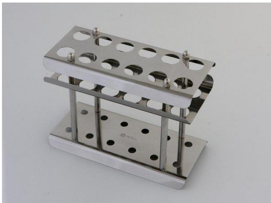
Suporte para butirômetro fabricada em aço inox 304 com capacidade para 12, 18 ou 24 provas.
