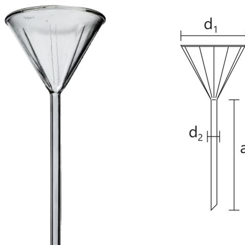
Utilizado para o processo de filtração. Vidro raiado com a haste longa e ângulo de 60°.
