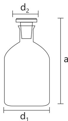
Utilizado para armazenamento de diversos reagentes e meios de cultura ou amostras líquidas. Importante para envase e armazenamento de soluções sensíveis a luz. Acompanha rolha de poli. Não Autoclavavel.
