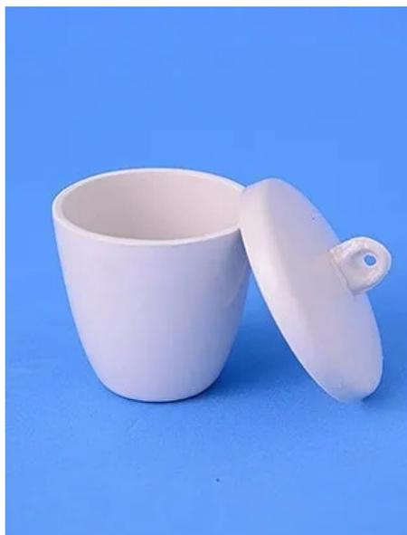
Utilizados para calcinação e fusão de materiais sólidos ou pastosos, normalmente em muflas, nas temperaturas entre 1.200 a 1.500°C.
