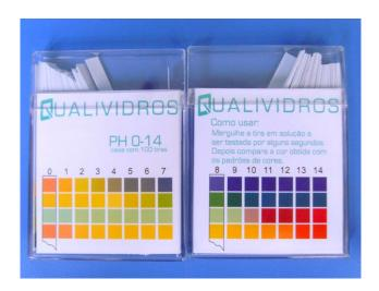
Utilizado em laboratórios de controle de qualidade, hidropônica, piscicultura, análise de água, entre outros. Indicado para a verificação direta do valor do pH em soluções aquosas. Fita com 4 cores, em caixa acrílica
