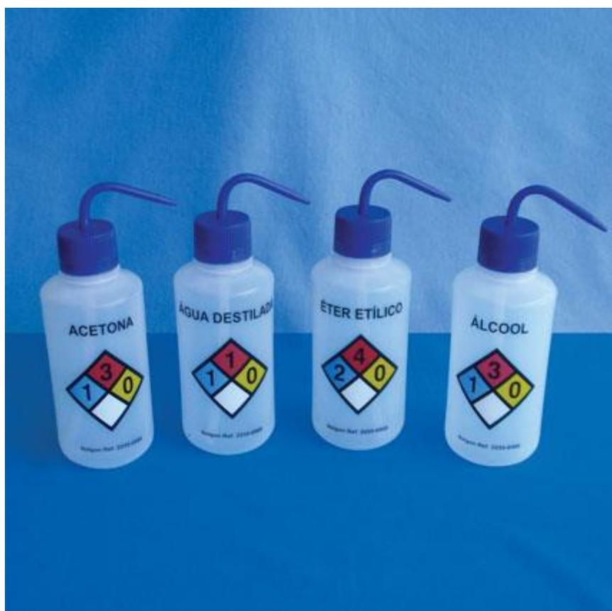
Pisseta com classificação de risco diamante de Hommel para vários produtos, como: Etanol, Metanol, Acetona, Isopropanol, Água Destilada, Xilol entre outros.
