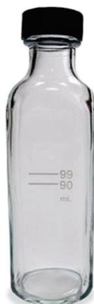
Utilizado em laboratórios de análise de alimentos, especialmente em testes de qualidade de laticínios. Sua aplicação primária reside na diluição de amostras de leite para análises microbiológicas, determinação de acidez, quantificação de componentes e outros procedimentos de controle de qualidade. Gravação em tinta cerâmica de alta durabilidade na cor branca;
