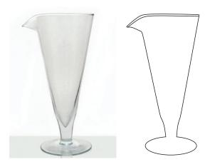
Utilizado para reter e conservar fluidos e compostos e facilitar a formação de precipitados em variadas reações químicas. Apresenta uma base em forma de cone ideal para sedimentações em processos de análises clínicas.
