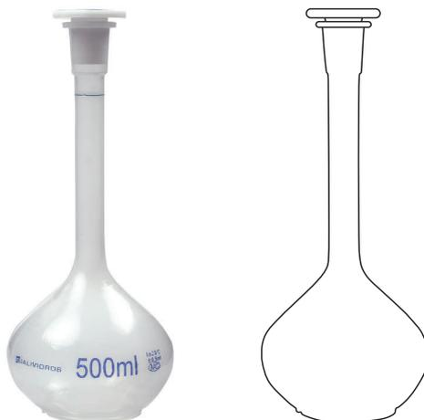
Utilizado para medir volumes de líquidos ou soluções de forma extremamente precisa e exata. A grande vantagem do balão de plástico é justamente a durabilidade, já que cada modelo é produzido com polipropileno reforçado para aumentar a resistência. Também é um material que torna o produto fácil de lavar. Acompanha tampa de poli.
