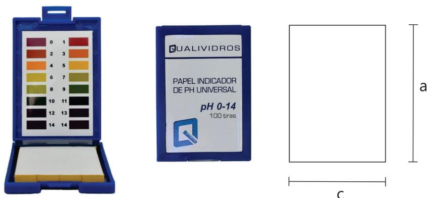
Utilizado em laboratórios de controle de qualidade, hidropônica, piscicultura, análise de água, entre outros. Indicado para a verificação direta do valor do pH em soluções aquosas.
