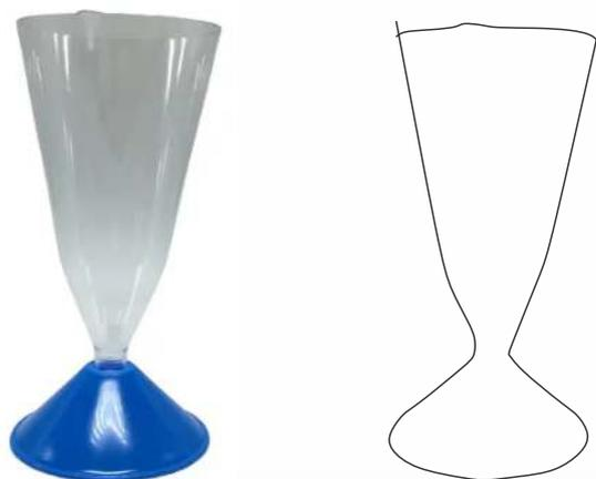
Utilizado para conter e armazenar líquidos e substâncias e obter precipitações a partir de diferentes reações químicas. Cálice ideal para sedimentação.
