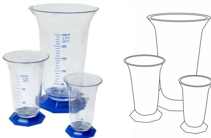
Utilizado para conter e armazenar líquidos e substâncias e obter precipitações a partir de diferentes reações químicas. Cálice ideal para sedimentação. Com graduação.
