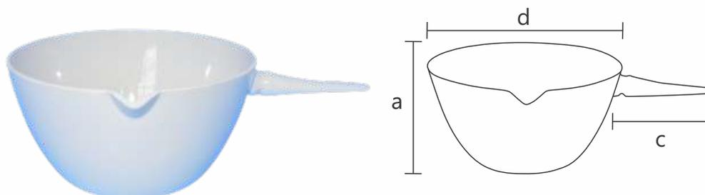
Utilizada no Bico de Bunsen ou chama direta de fogão a gás para a fervura, cozimento ou até a simples evaporação. Suportam temperaturas, especificamente nos estados de ebulição, com resistência a choque térmico entre 400/500°C para 20°C. Não deverá ser usada sem a presença de líquidos em seu interior.
