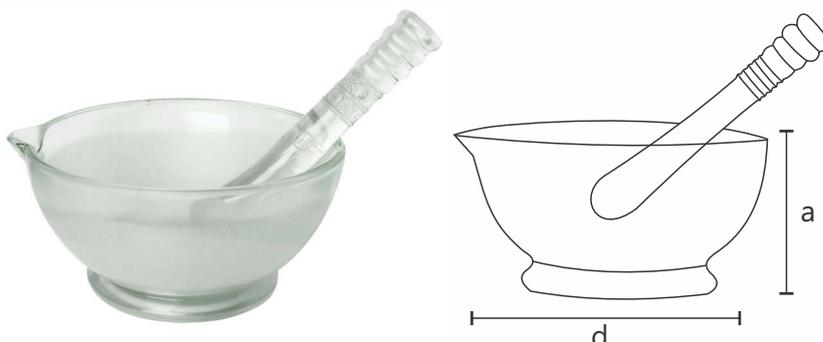
Utilizado na trituração de pequena quantidade de pós, na mistura de pós já triturados e na formulação de suspensões, emulsões e pomadas.
