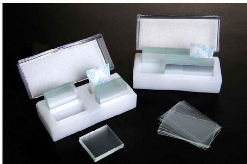
Utilizada em conjunto com a câmara de Neubauer, que é um dispositivo usado principalmente para contar células em suspensão, como células sanguíneas. A lamínula é colocada sobre a câmara de Neubauer após a adição da amostra e serve a vários propósitos: Uniformização do volume, distribuição uniforme da amostra, proteção da amostra, facilitação da visualização
