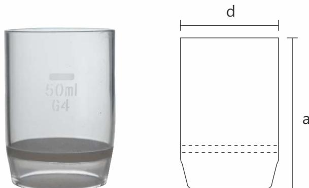
Utilizado para recolher um precipitado diretamente dentro do recipiente onde será seco, possivelmente com vazamento, e posteriormente pesado em análise gravimétrica. O cadinho de Gooch também pode ser empregado para coletar e processar amostras de tecido biológico dentro do mesmo recipiente.
