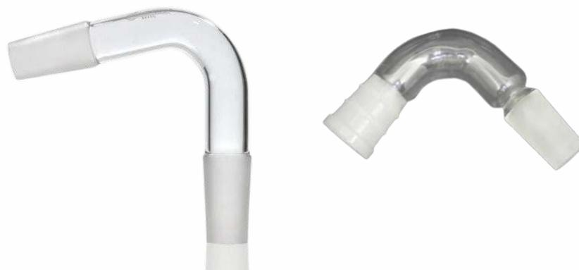
Utilizado para unir o condensador ao recipiente de coleta em processos de destilação, controlando a direção do líquido em movimento. Autoclavável a 121°C. Características Adicionais: Junyas Esmerilhadas, 2 Juntas Macho 45/50 e 24/40
