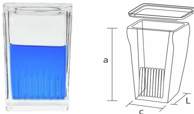
Utilizada em diversos protocolos de Análises Clínicas sendo ideal para o processo de coloração de lâminas.
