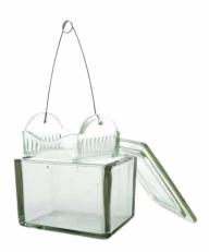
Utilizada em diversos protocolos de Análises Clínicas sendo ideal para o processo de coloração de lâminas. Com tampa de vidro. Autoclavável a 121°C. Para 8 Lâminas 76 x 26 mm
