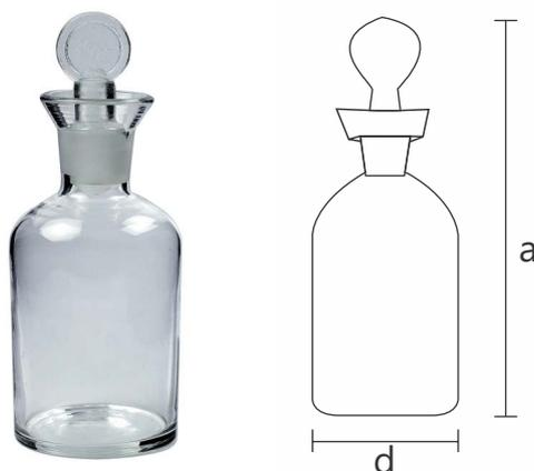
BOD é uma abreviatura em inglês Biochemical Oxygen Demand, que aqui no Brasil utilizamos a sigla DBO que significa Demanda Biológica de Oxigênio. Com ou sem aferição. Número de série gravado no frasco e na rolha; capacidade: (300,0 +/- 10,0) ML; Espessura da parede maior que 2mm; Transparência a luz maior que 92%; Atendendo as normas ASTM-E-438;
