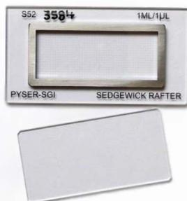
Fabricada para proporcionar o máximo de confiabilidade, principalmente, na análise de plâncton. Possui uma longa durabilidade que permite executar os trabalhos sem resultar em desgaste das peças.
