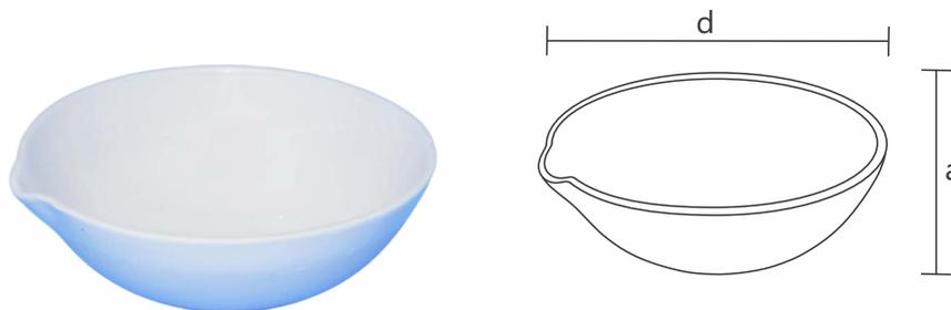
Utilizado para evaporação de líquidos, em areia aquecida, chapa, Bico de Bunsen, e em muflas, no máximo a 600°C. Suportam bem choque térmico de 400 para 20°C. Dada sua forma, quanto maior o diâmetro, maiores deverão ser os cuidados no aquecimento, que deverá ser lento e gradual, observando idênticos cuidados no resfriamento.
