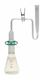
Utilizado para determinação de arsênio pelo método fotométrico de dietilditiocarbamato de prata. Possui juntas de vidro esmerilhadas.
