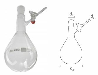
Utilizado em pesquisa química ou laboratorial de materiais para realizar experimentos sob vácuo e atmosfera inerte (como nitrogênio ou argônio).
