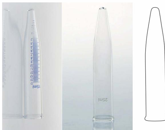
Utilizado para centrifugação com fundo cônico e fabricado em vidro graduado ou em vidro sem graduação.
