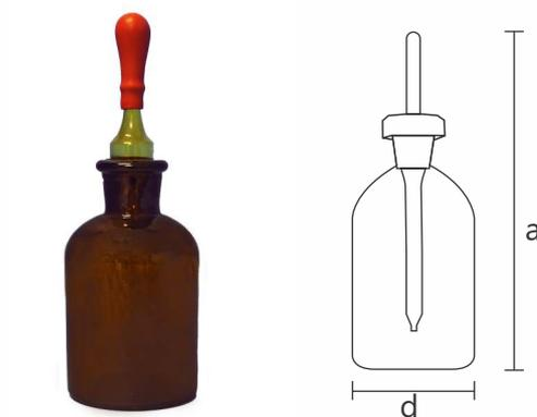
Utilizado para armazenar líquidos que precisam ser medidos em gotas, sendo um recipiente prático e de fácil utilização. Acompanha pipeta esmerilhada e tetina de borracha.
